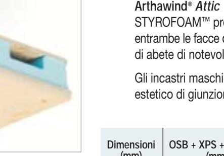
Arthawind® Attic V è composto da un nucleo termoisolante in polistirene estruso monostrato STYROFOAM™ provvisto di scanalature per la microventilazione sottotegola e ricoperto su entrambe le facce da una lastra di OSB e su quella a vista da una finitura in monostrato lamellare di abete di notevole valore estetico.
