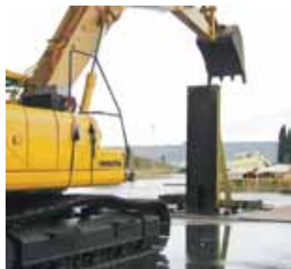
PC340 Demolizione, con carico di torsione applicato alla prima parte del braccio demolizione.
