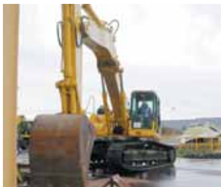
PC340 Demolizione, con braccio da scavo installato sollecitato da un carico di torsione e di flessione contemporanei.
