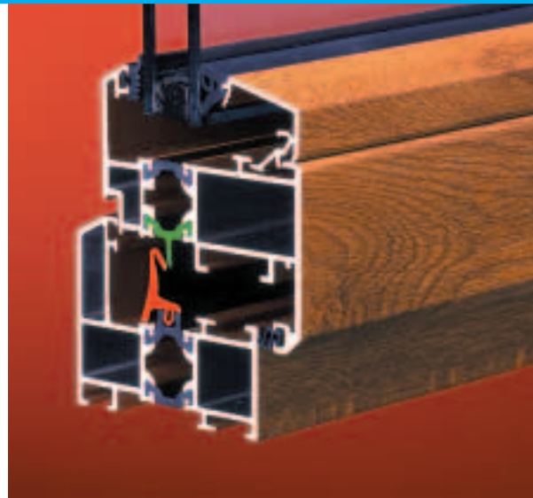
Sistema del giunto aperto: l'aria entra nella precamera e spinge la guarnizione contro le "pinne". Più l'aria spinge, più la guarnizione aderisce.
