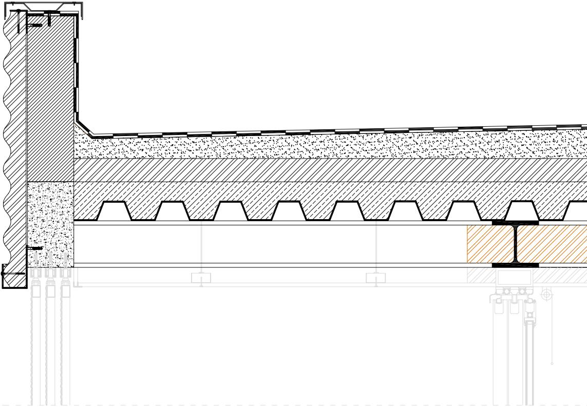
posa del pannello in lana minerale - spessore 40mm - Potere fonoisolante  $R_w = 50\text{db}$  - Resistenza al fuoco classe europea A1
