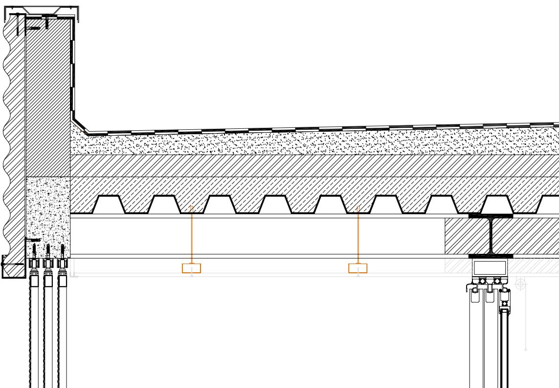
Montaggio del sistema di ancoraggio delle lastre di cartongesso.
