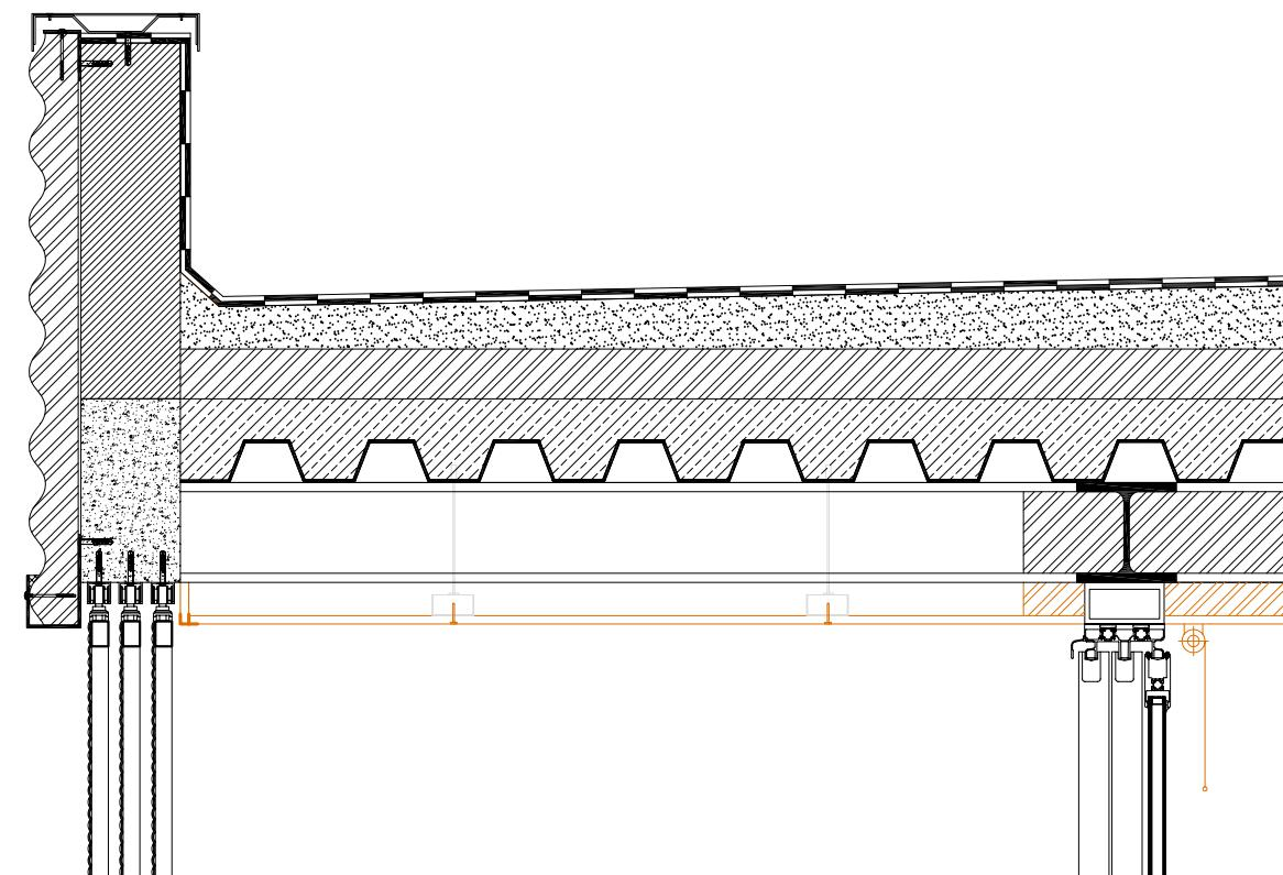
Montaggio delle lastre in cartongesso - spessore 1,25 cm,
