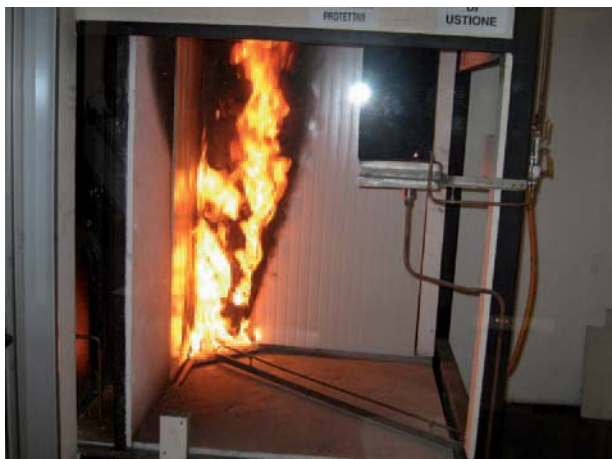
Pannelli sandwich sottoposti a test SBI
