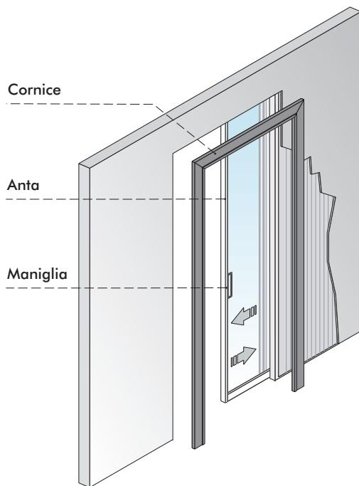
Le ante **ACQUA** hanno struttura in alluminio e vetri a tamponamento delle stesse e possono essere applicate sul controtelaio Scrigno Base.
