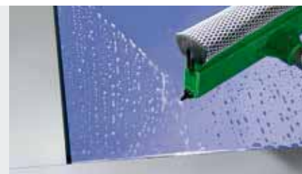
Finestratura in materiale sintetico DURATEC estremamente resistente ai graffi.
