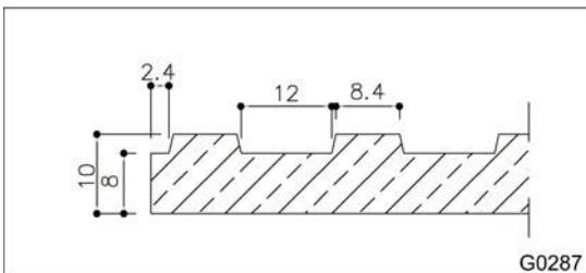
Le dimensioni delle scanalature sono puramente indicative. Sono dimensioni nominali soggette a delle tolleranze. Le scanalature sono eseguite sulla direzione longitudinale delle lastre.
