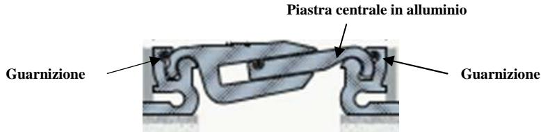
Il principio di assemblaggio di questo coprigiunto consente importanti movimenti verticali ed orizzontali. Le guarnizioni assicurano la tenuta nel tempo alle impurità, acque di lavaggio ed eliminano l'attrito tra l'alluminio. (rumore, usura ...)
