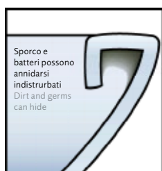
Vaso tradizionale con la brida Conventional toilet with rim
