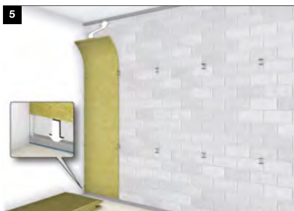
5. INSERIMENTO MATERIALE ISOLANTE NELL'INTERCAPEDINE
