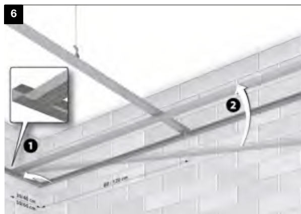
6. INSERIMENTO PROFILI PRIMARI NELLE GUIDE E ESUCCESSIVO AGGANCIO AI PENDINI
