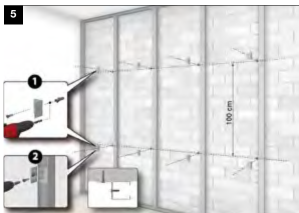
5. POSIZIONAMENTO E FISSAGGIO DEI PUNTI DI ANCORAGGIO MECCANICO ALLA PARETE E AI MONTANTI
