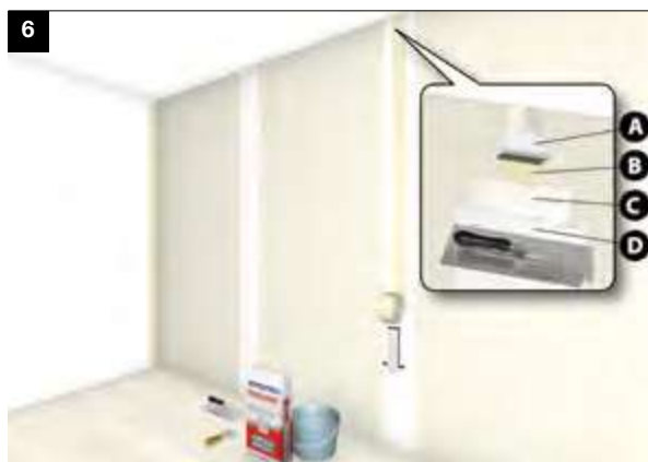
6. TRATTAMENTO DEI GIUNTI A. Stucco B. Nastro di rinforzo C. Stucco D. Finitura
