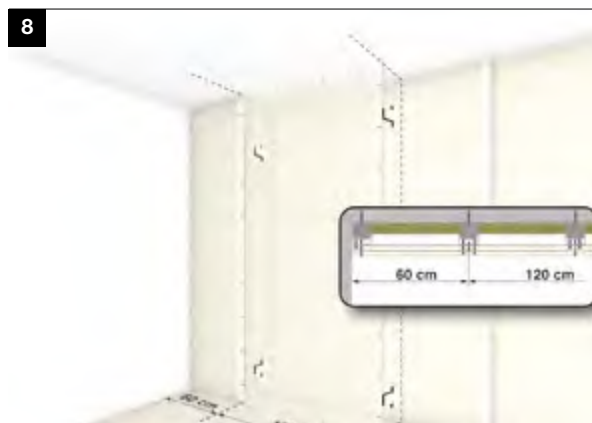
8. POSIZIONAMENTO E AVVITATURA DELL'EVENTUALE SECONDO STRATO DI LASTRE
