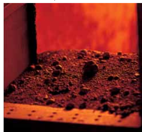
Cottura a 1.200 gradi ed espansione.
