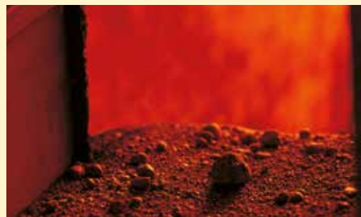
Cottura a 1200°C ed espansione.
