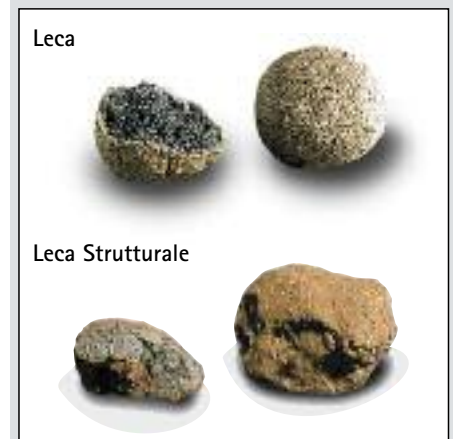
Granulo di Leca (in alto) e Leca Strutturale (in basso): la struttura porosa del materiale costituente il granulo è racchiusa in una scorza dura e resistente.
