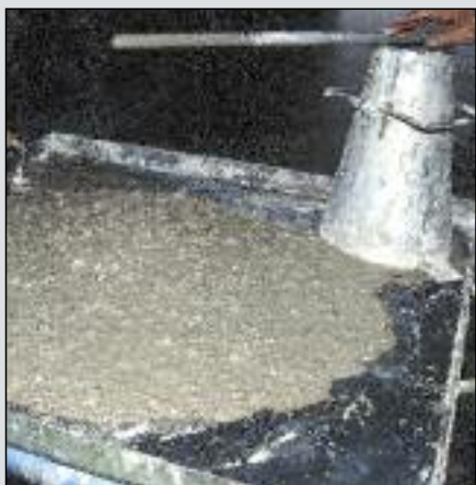
Prova di spandimento.
