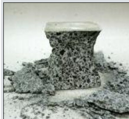
Cubetto sottoposto a rottura.
