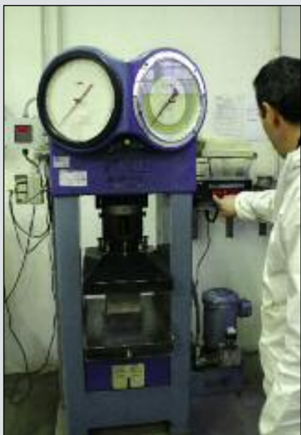
Pressa per determinazione resistenza a compressione.
