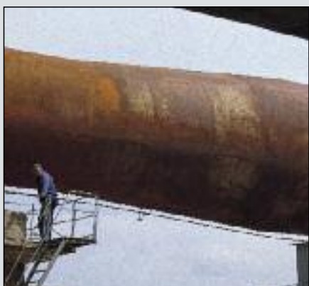
Il forno rotante per la cottura dell'argilla.
