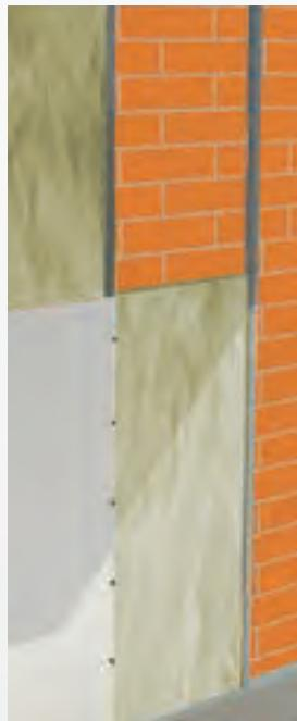
L'isolamento delle pareti perimetrali dall'interno consiste nell'applicazione di una controparete costituita da pannelli di gesso rivestito montati su un telaio metallico associato ai pannelli di lana minerale. È un sistema molto usato negli interventi di ristrutturazione, soprattutto quando non è possibile intervenire dall'esterno.
