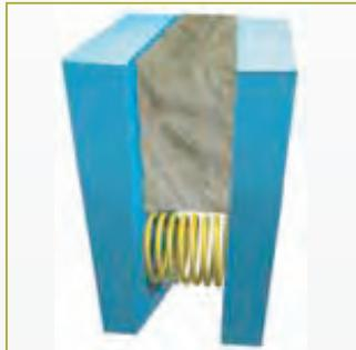
L'efficacia acustica dei sistemi a secco, composti da lastre in gesso rivestito su struttura metallica ed intercapedine riempita con lana minerale URSA Terra, si fonda sul **sistema massa – molla – massa**. La lana minerale agisce da attenuatore delle vibrazioni acustiche grazie alla sua elasticità e riduce la risonanza nella cavità mediante la sua struttura a celle aperte;
