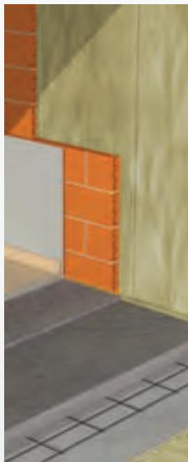
L'isolamento in intercapedine delle pareti divisorie in laterizi è il sistema più usato nella separazione dei locali adibiti ad abitazione. La parete divisoria è realizzata con elementi forati di laterizio formanti due tavolati paralleli con interposto uno strato isolante costituito da un pannello in lana minerale URSA Terra Plus 70, per isolare sia termicamente che acusticamente l'abitazione. In tal modo, si ottengono maggiore comfort e risparmio energetico.
