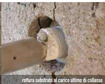
prove di infissione sui giunti di malta di allettamento
