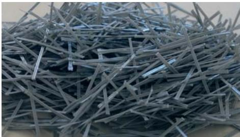
Le fibre migliorano le prestazioni del massetto in termini di resistenza e flessione ed evitano la formazione di microfessurazioni.
