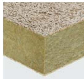
Pannelli compositi, in Euroclasse A2-s1, d0, a due o tre strati in lana di legno mineralizzata e legata con cemento Portland bianco e polvere minerale accoppiati a pannelli in lana di roccia.
