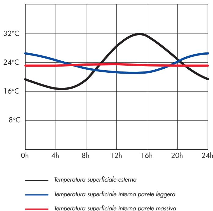
Nel grafico a fianco si confrontano il comportamento estivo di due pareti aventi uguali caratteristiche di isolamento termico ( $U=0,32 \text{ W/m}^2\text{K}$ ). La prima è una parete massiva, realizzata con blocchi Poroton Plan e avente una massa superficiale superiore ai  $230 \text{ kg/m}^2$  (linea rossa), mentre la seconda è una parete leggera, con massa superficiale di  $160 \text{ kg/m}^2$  (linea blu).
