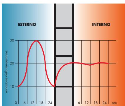
Per poter realizzare un edificio confortevole ed energeticamente efficiente l'isolamento non è il solo aspetto da considerare, anche l'inerzia termica della parete, capacità di accumulare e rilasciare calore, ricopre un ruolo di notevole importanza. Come dimostrato da una recente ricerca condotta dal Dipartimento BEST del Politecnico di Milano, questa caratteristica è lega-
