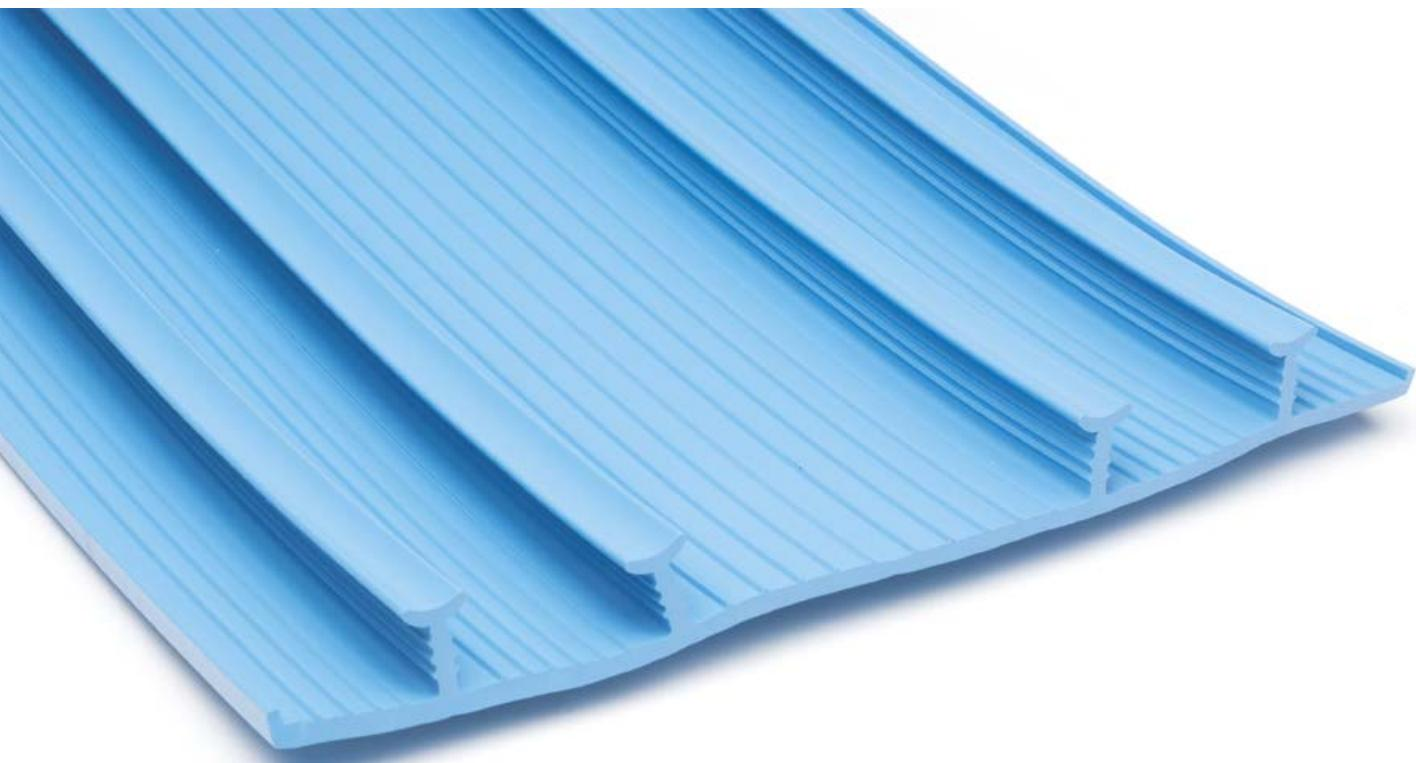
Il profilo **WATERSTOP "4TV"** è utilizzato per l'impermeabilizzazione nella ripresa di getto con posa esterna e assicura la tenuta idraulica anche in presenza di pressione.
