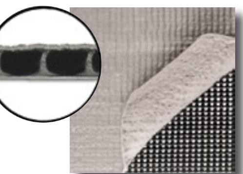
**Tenax DR1 (Drainage)** è un prodotto che assolve contemporaneamente alle funzioni di filtrazione (passaggio di acqua attraverso uno strato permeabile), di drenaggio (allontanamento dell'acqua non appena filtrata) e di protezione meccanica del supporto impermeabilizzato.
