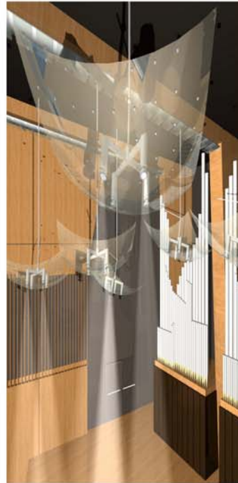
PANNELLO PER LA DIFFUSIONE E LA FLESSIONE SONORA REALIZZATO IN LASTRE DI METACRILATO TERMOFORMATO
