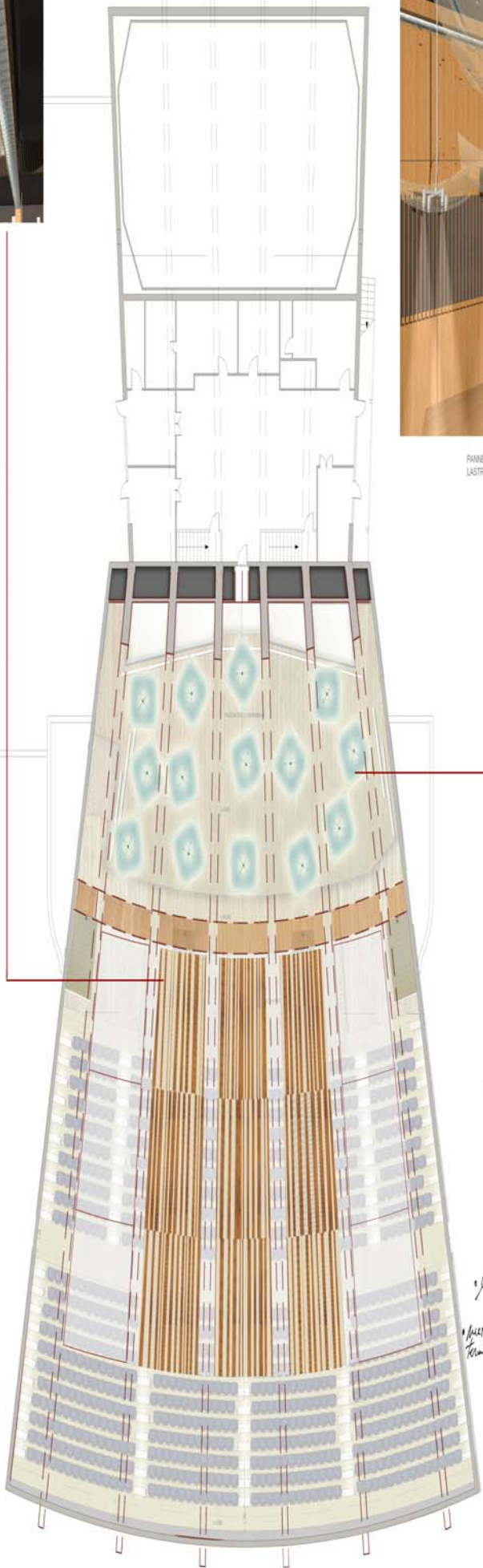
Pianta delle Controssoffitture SC. 1100
