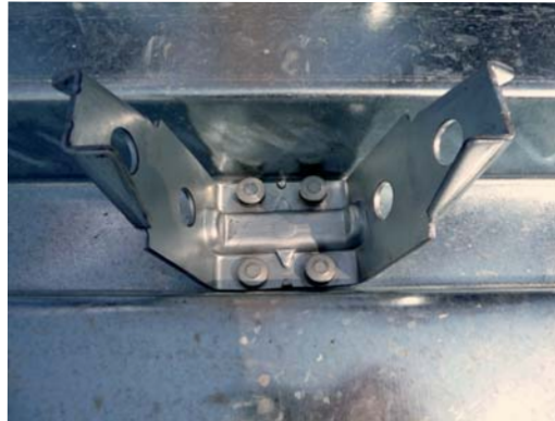
Push out test presso il laboratorio della facoltà di Ingegneria dell'Università di Padova e presso il laboratorio Tecnaria.
