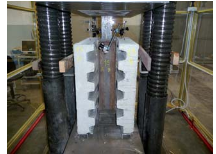
Push out test presso il laboratorio della facoltà di Ingegneria dell'Università di Padova e presso il laboratorio Tecnaria.
