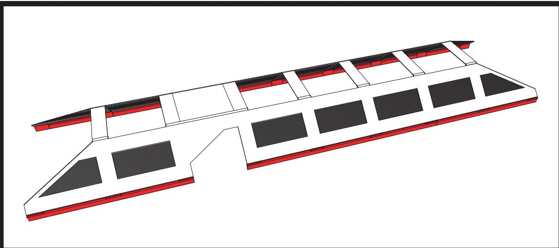
L'ATTACCO A TERRA E' COSTITUITO DA UN BASAMENTO IN CALCESTRUZZO ARMATO, ANCORATO A TERRA, DA DUE TRAVI IN FERRO E DA UN SUPPORTO IN ACCIAO. HA LA FUNZIONE DI SOSTENERE GLI ELEMENTI 01, 02 E 03. INFATTI, GLI ESTRUSI VANNO AD APPOGGIARSI SULLA TRAVE A "C" LA QUALE VIENE FISSATA TRAMITE BULLONI E TIRANTI.
