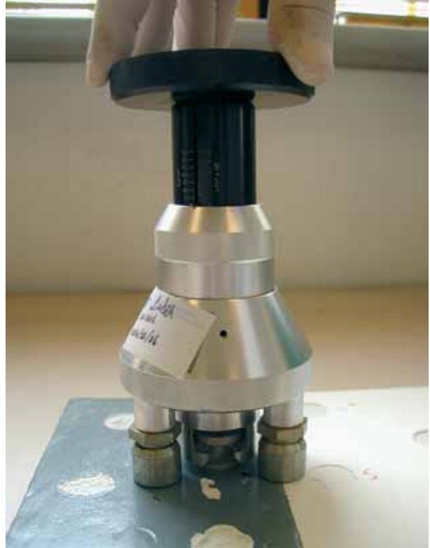
Le foto mostrano le varie fasi di misura di adesione utilizzando l'apparecchiatura del metodo di Pull-of
