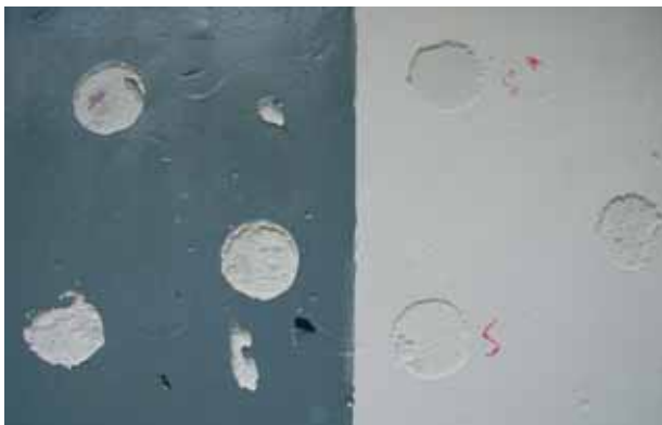
Le foto mostrano le varie fasi di misura di adesione utilizzando l'apparecchiatura del metodo di Pull-of
