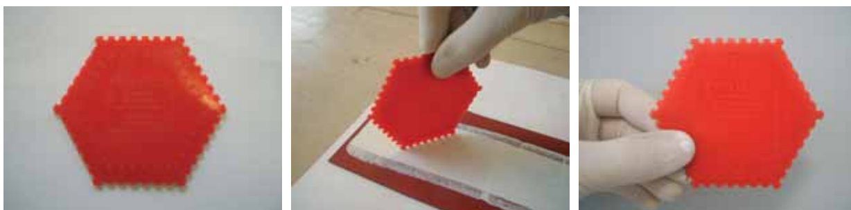
La sequenza fotografica mostra l'utilizzo del pettine per il rilievo di spessore a umido. La foto a sinistra evidenzia una serie di denti bagnati dalla vernice bianca: il primo dente (a destra nella foto) non bagnato (dalla vernice bianca) rappresenta la misura a umido del prodotto applicato.
